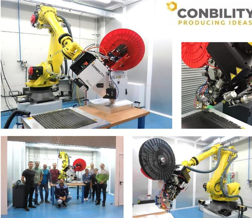
Bild 1: Tape Placement Applikator "PrePro 3D" im Technikum von AIMEN in Spanien.
